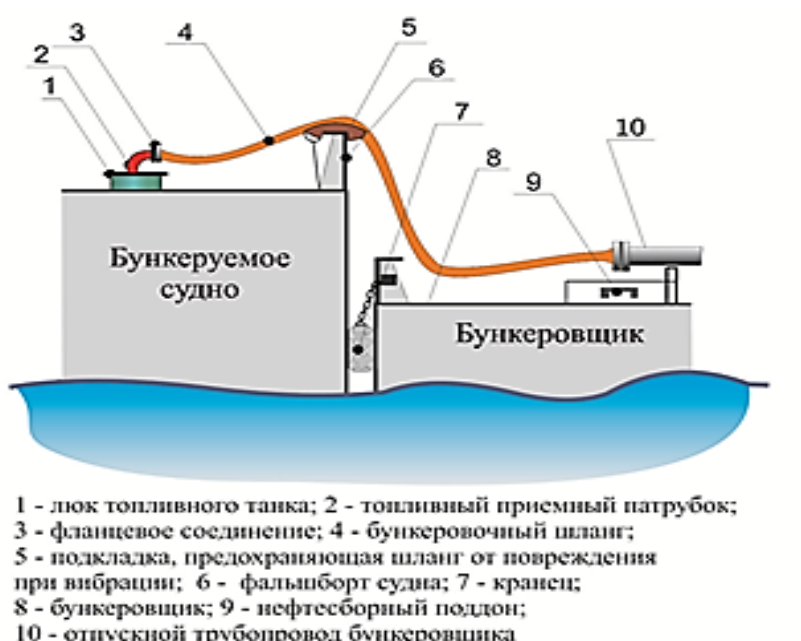
Рисунок 2.4-1. Передача топлива от бункеровщика к судну-приемнику с использованием судовых гибких грузовых шлангов
